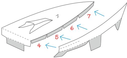
Je colle les flancs de coque 4 à 7 puis 8 à 11 sur le côté du pont en partant du tableau arrière
